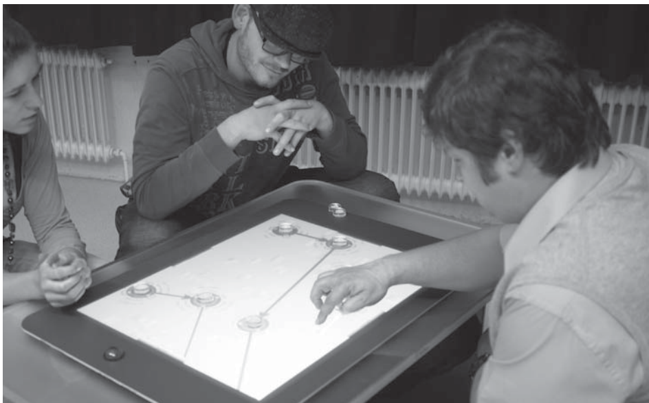
Abb. 11: Facet-Streams erlauben die kollaborative facettierte Suche in Produktkatalogen durch eine Kombination von TUIs und InfoVis (Lit. 19)
