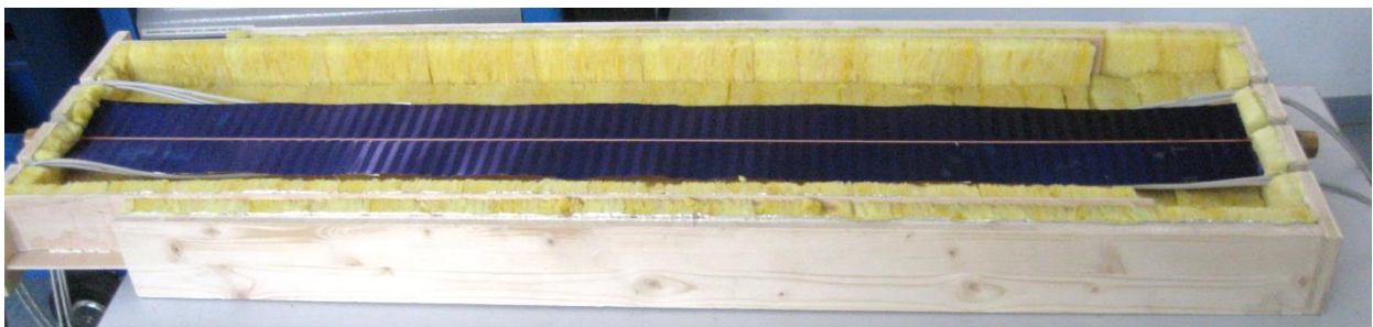
Abbildung 6: Aufnahme der Absorberfinne in wärmegeämmter Holzbox
